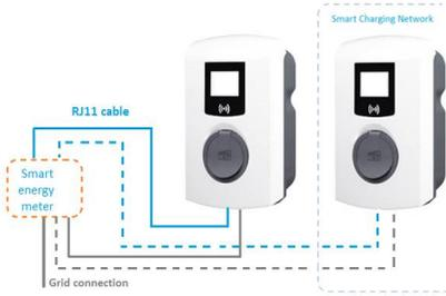
Abbildung 5.2: Aktive Lastverteilung mit einem Energiezähler (P1-Anschluss)
